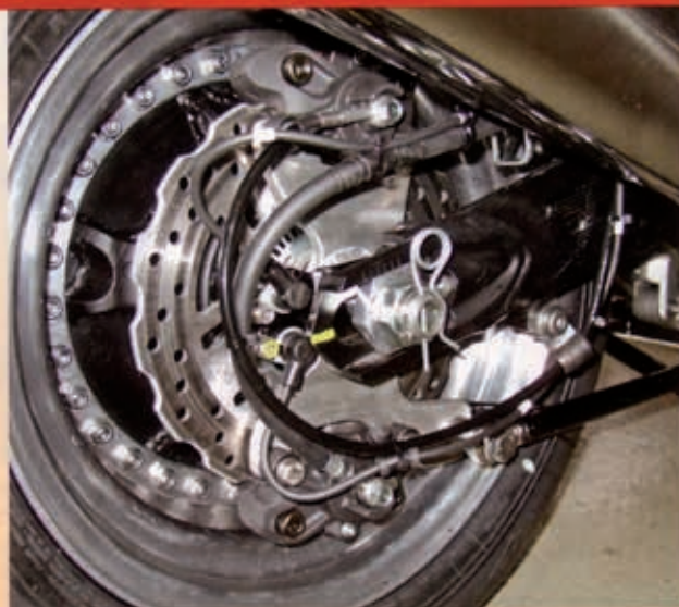
Das doppelte Integralbremssystem mit ABS-Steuerung im Hinterrad: Eine Entwicklung der Firma Müller-Gespannbau und Peter Sauer.
